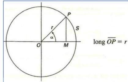
El sistema circular, para la medición de ángulos, toma como unidad un ángulo cuyo arco abarque la misma longitud que el radio de la circunferencia ( $S=r$ ), a este ángulo se le denomina radián. Un ángulo de  $x$  radianes abarca un arco de longitud  $S = x \cdot r$ .
